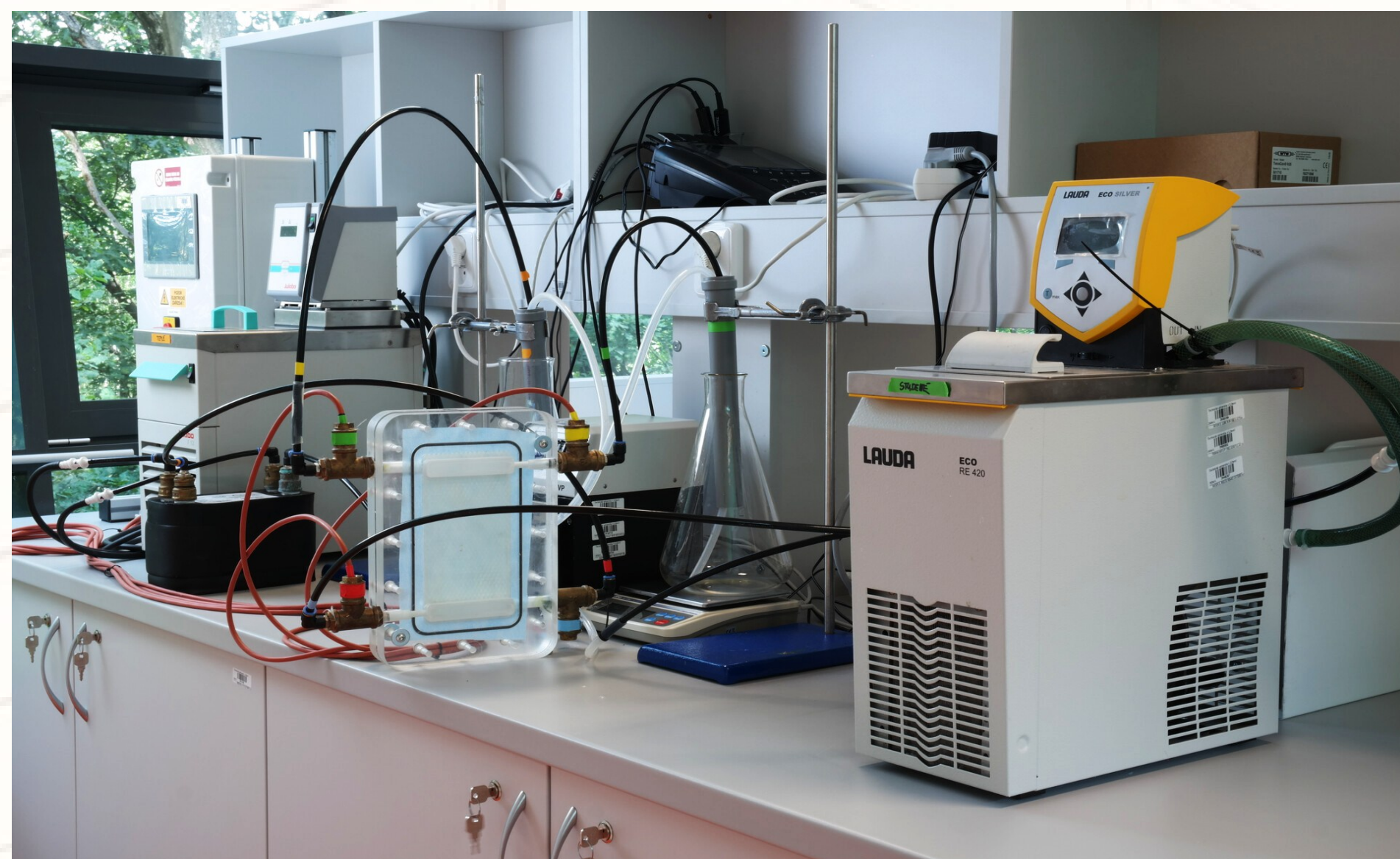
Obr. 1: Laboratorní jednotka membránové destilace (DCMD).
