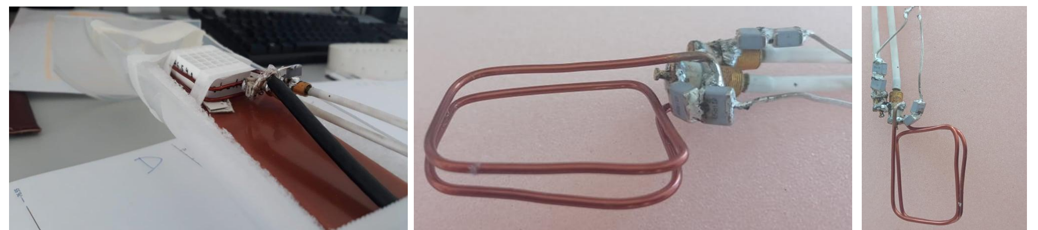
Obr.2: Radiofrekvenční cívka specializovaná k náběru dat MRI-QR.
