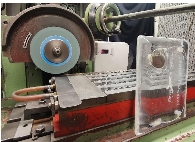
Obr. 1: Vytvořený fantom s kardiostimulátorem při měření v blízkosti elektromagnetického upínáku
