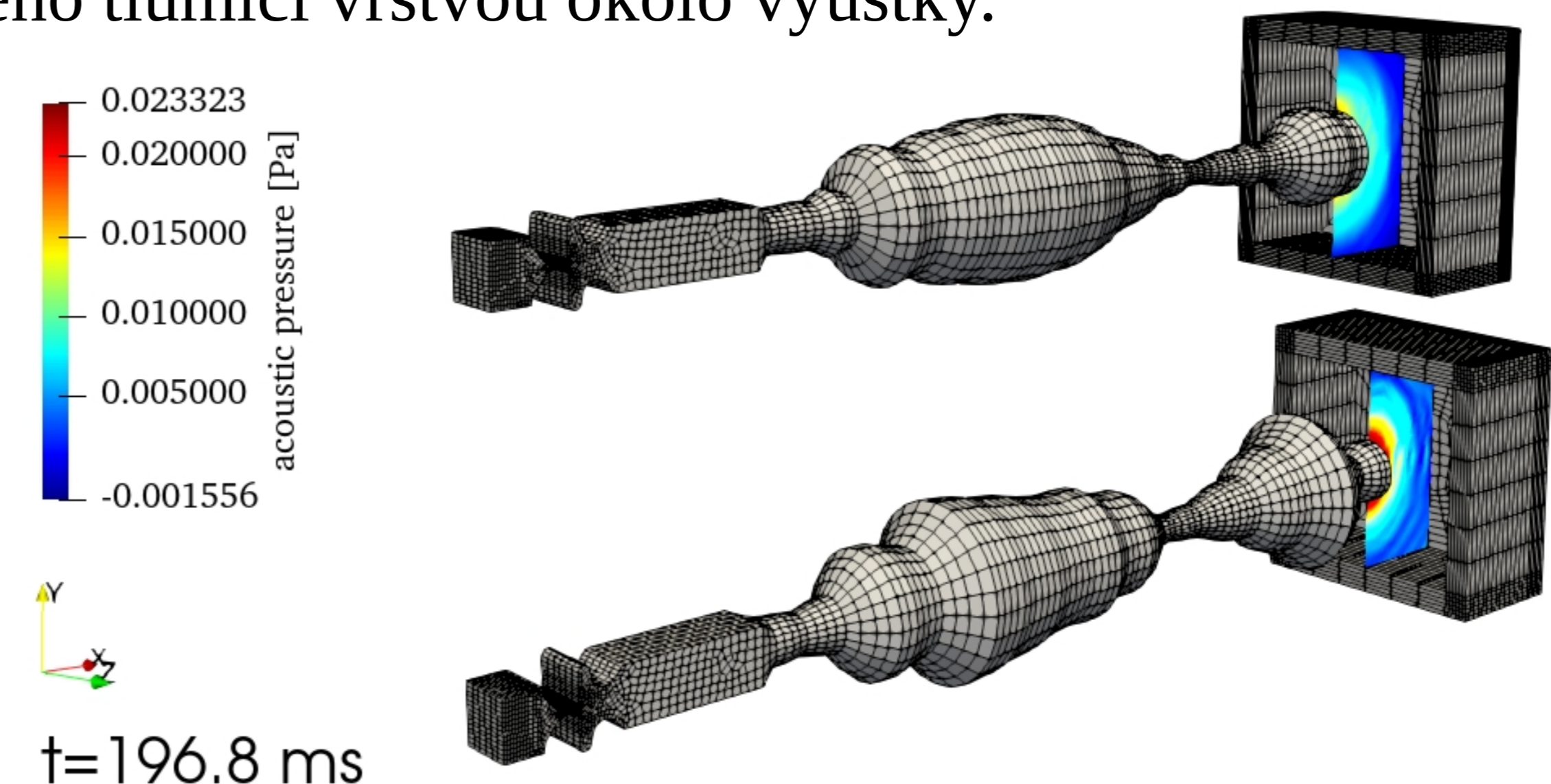
Obr. 2 – Celá výpočetní oblast a zobrazení průběhu akustického tlaku
