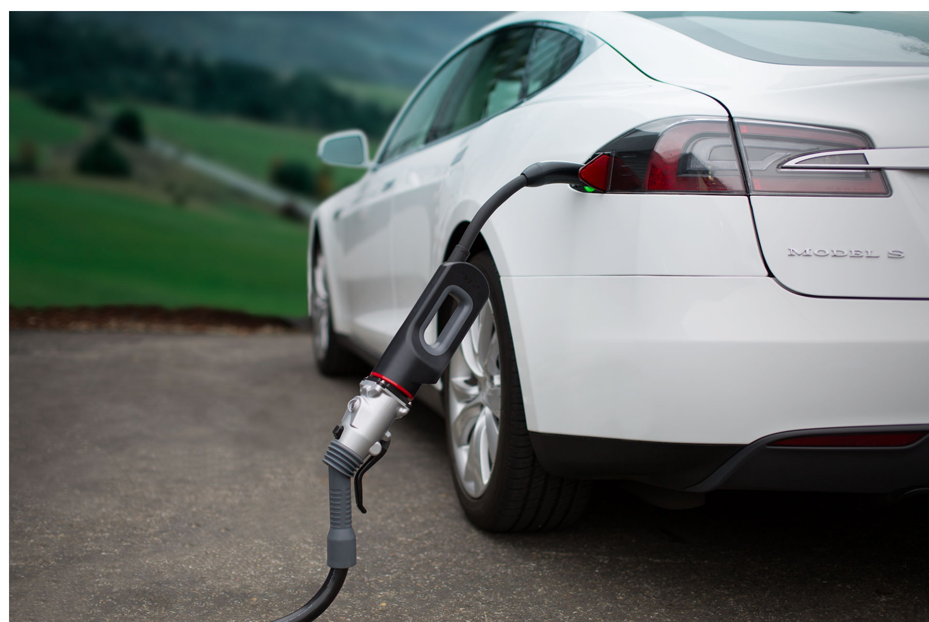
Tesla Model S dobíjená pomocí standardu CHAdeMO. Vozy této značky neobsahují dobíjecí zásuvku typu CHAdeMO. Majitelé si musí dokupovat adaptér CHAdeMO/Supercharger. Tento adaptér stojí cca $600.
