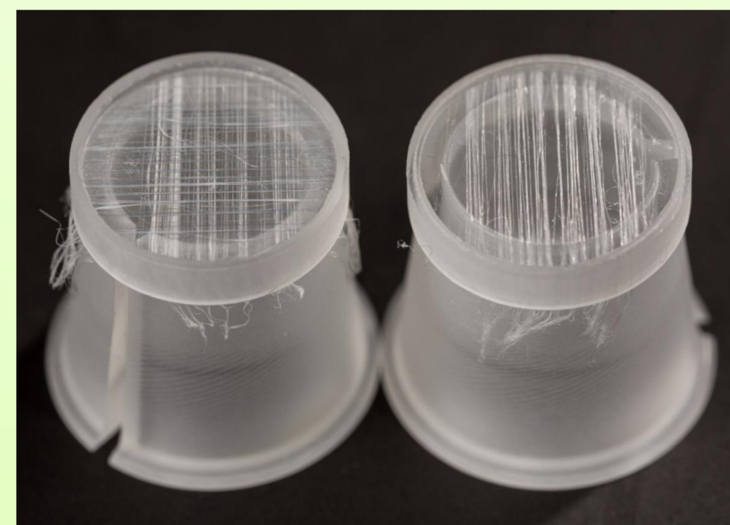
Obrázek 1: Vlákná vyrobená metodou drawing upevněná na kónickém držáku.
