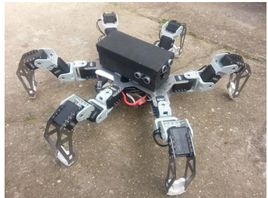
Obrázek 1. Konstrukce robota včetně webové kamery a senzorů.
