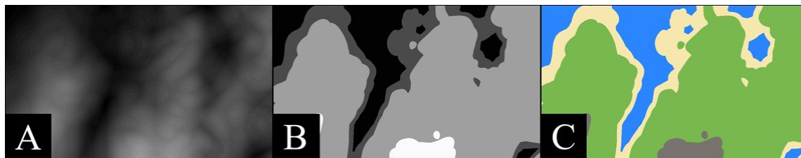
Obrázek 1: Generování terénu pomocí perlinova šumu. A - Perlinův šum; B - Prahování; C - Vrstvy terénu
