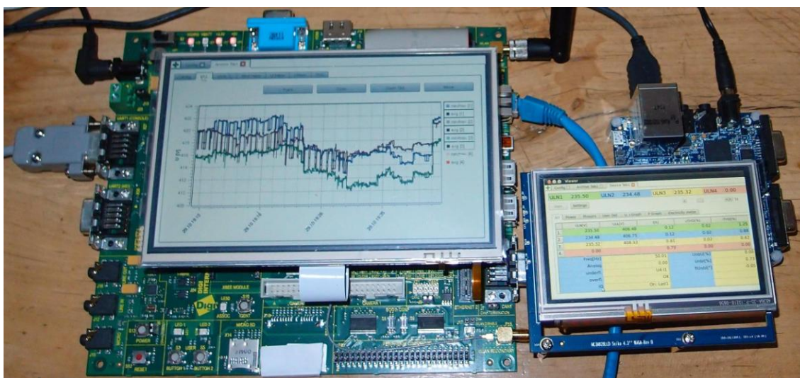
Obrázek 1 Běžící grafický klient na obou vývojových kitech. Vlevo Digi ConnectCore se zobrazují archivní hodnoty, vpravo Freescale QSB se zobrazují aktuální data.
