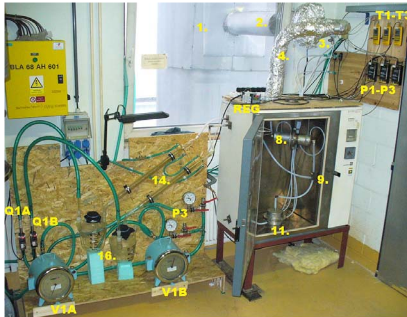
Obrázek 1: Zařízení k testování katalytických filtrů.
